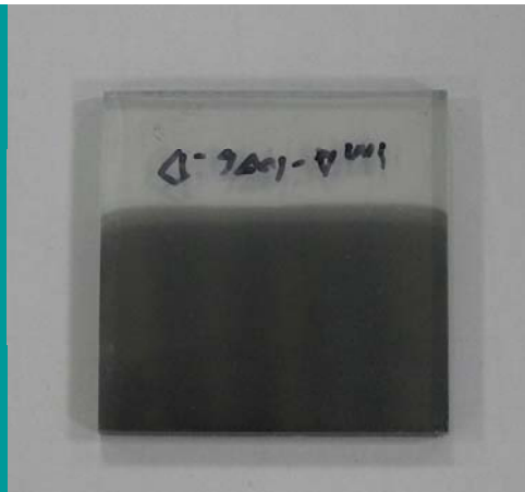
(c) 直流電鍍白金電極( Q=100\text{ mC} )
