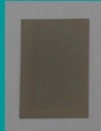
(b) 濺鍍白金電極( t=4\text{ min} )
